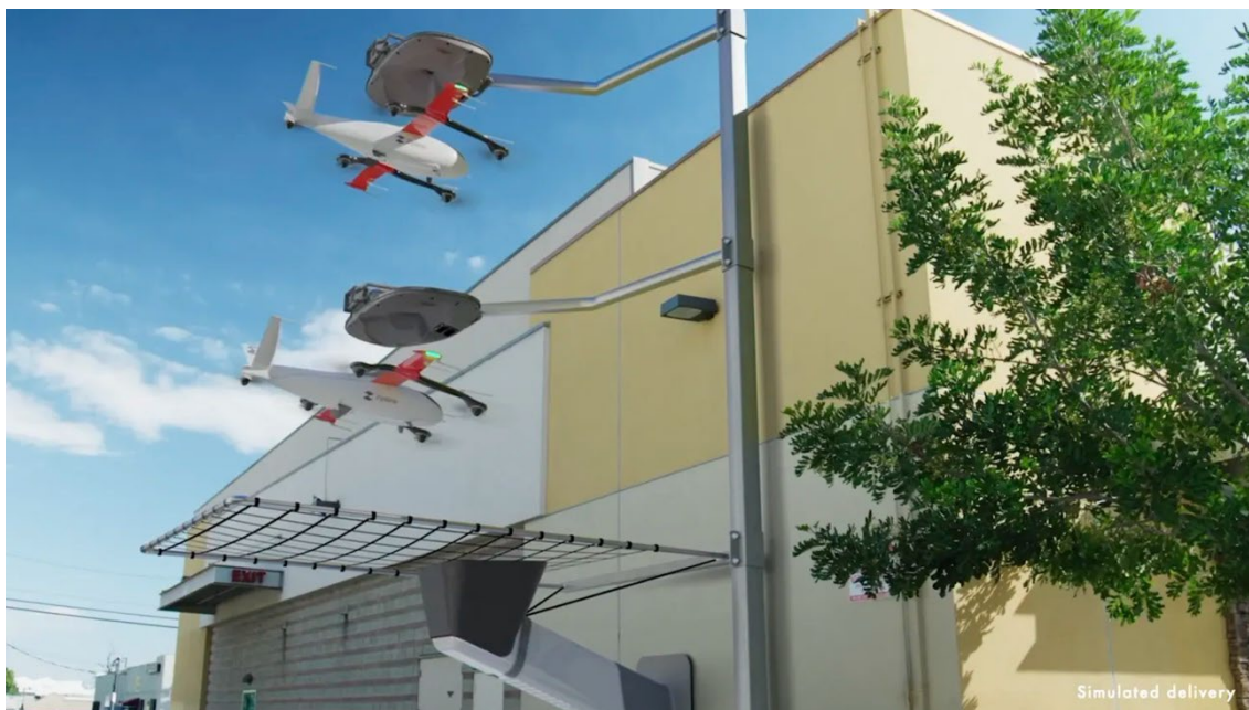
Figur 13: Konceptbild från Zipline på landningsstruktur för modell Plattform 2. Strukturen är utformad för autonom landning, laddning och lastning av drönare inom ett begränsat markutrymme. Källa: Zipline
